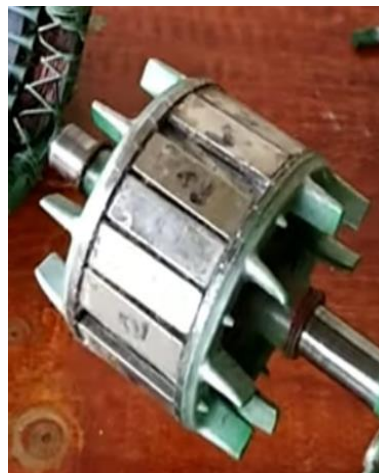
Gambae 7. Contoh Pemasangan 6 Buah Magnet pada Rotor
