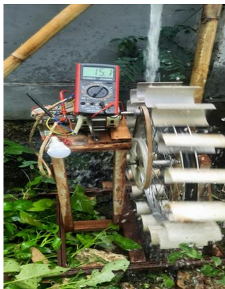
Gambae 10. Pengukuran Tegangan Generator Menggunakan Beban
