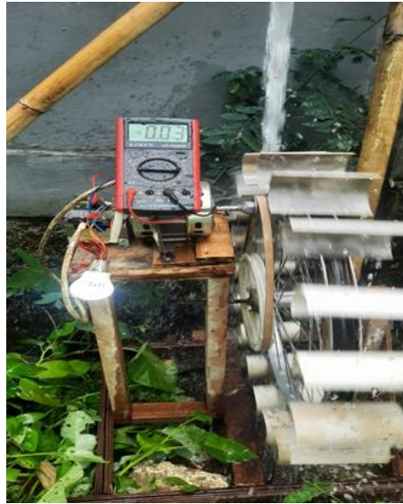
Gambae 11. Pengukuran Arus Traffo Menggunakan Beban
