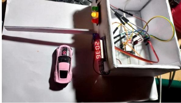
Gambar 6. Smart Gate Kondisi Menutup
