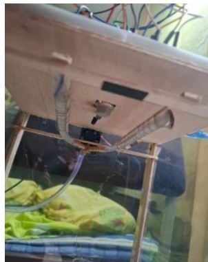
Gambar 6. Tampilan dalam ruang uji yang menunjukkan letak sensor dan percabangan selang air
