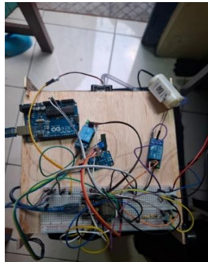
Gambar 5. Tata letak sirkuit mikrokontroler ESP32, Arduino Uno, dan relay pada panel atas
