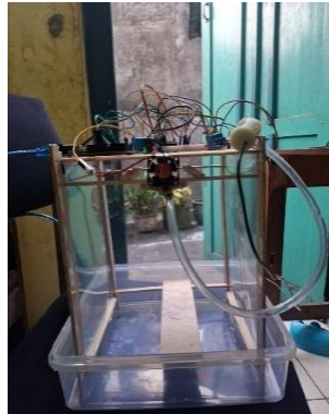
Gambar 4. Tampilan samping purwarupa ruang uji transparan beserta aktuator kipas dan selang pompa
